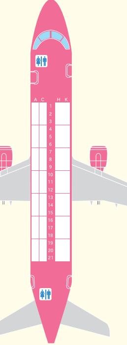
運航に使用する機体は、エンブラエル社製の最新鋭ジェット機E170/175。全長29.9m/31.7m、全幅26m(9号機以降 28.65m)と小型ながら、同サイズの従来機に比べて天井が高く、通路を挟んで左右に2席ずつ配した客席は、ゆったりとした空間と窓からの良好な視界が特徴です。
